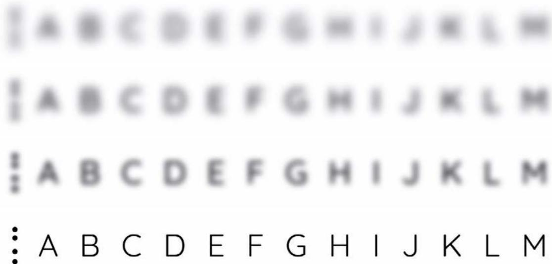
Abbildung 18: Buchstabenhöhe 6,5mm Auflösung 300 Pixel/Zoll | Radius des Gaußscher Weichzeichners von oben nach unten: 20px | 15px | 10px | 0px
