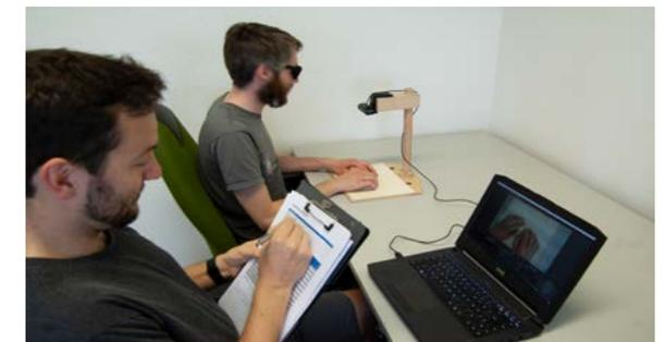
**Abbildung 16:** Versuchsaufbau Versuch 1 – Zu sehen ist der hölzerne Fühlrahmen, an dessen Stativ eine Webcam samt Mikrofon fixiert wurde. Der Rahmen konnte während der Erkundung verschoben werden ohne, dass die Videoaufnahmen der Hände davon beeinflusst wurden. Die in der Teilnehmerposition abgebildete Person ist kein Proband, sondern der Kollege des Autors, welcher sich zur Darstellung des Versuchsaufbaus zur Verfügung gestellt hat.
